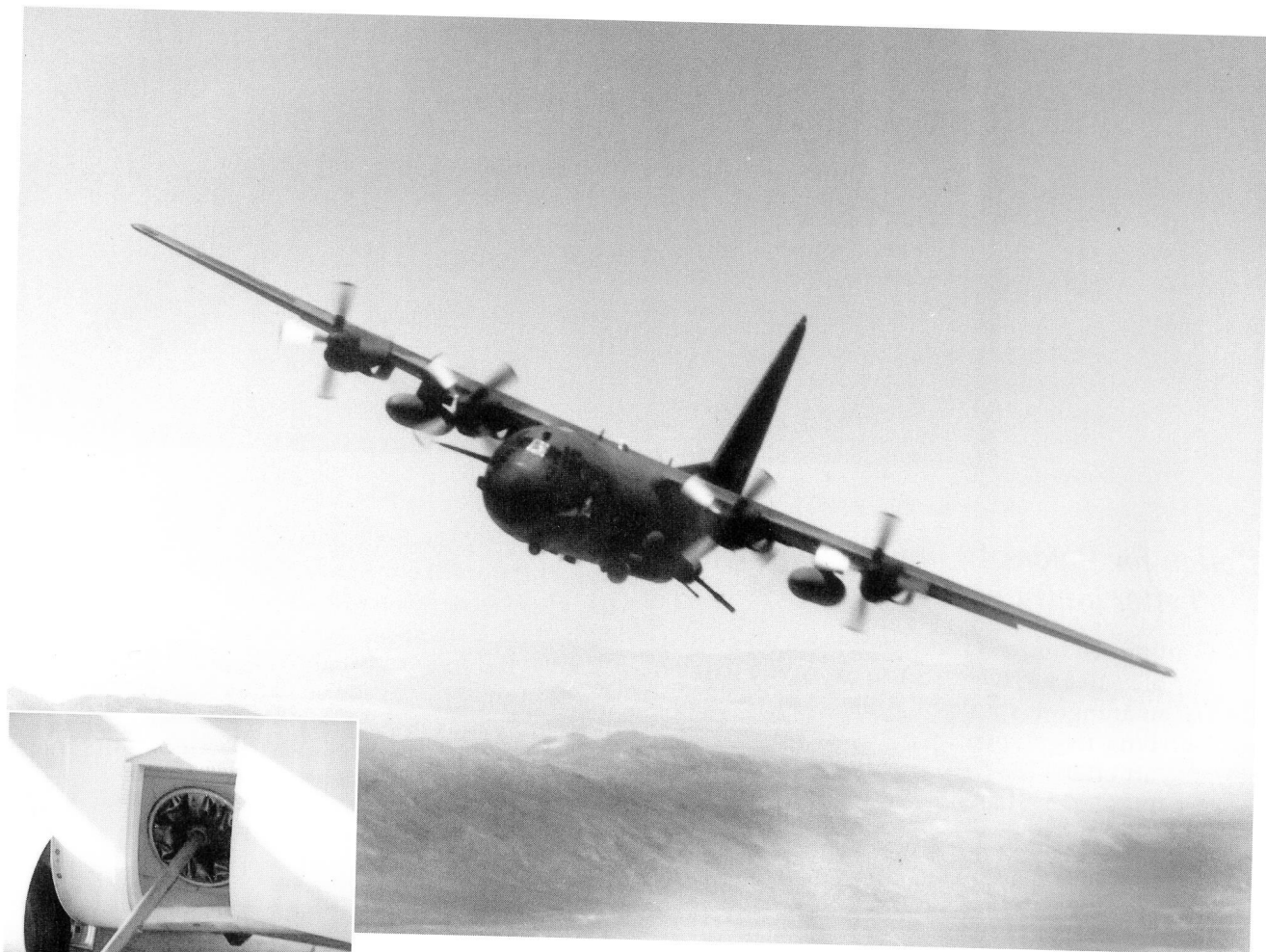
Bofors 40 mm luftvärnspjäs L/60 monterad i transportflygplanet Hercules, med beväpning benämnd Gunship. Utöver L/60 syns på flygplanbilden en 10,5 cm artilleripjäs.
